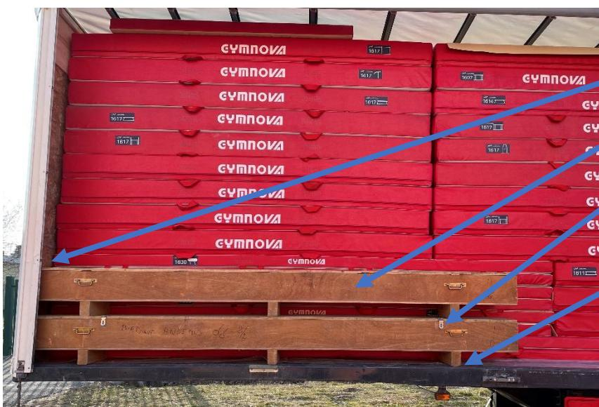
Caler les caisses derrière le châssis avant.
