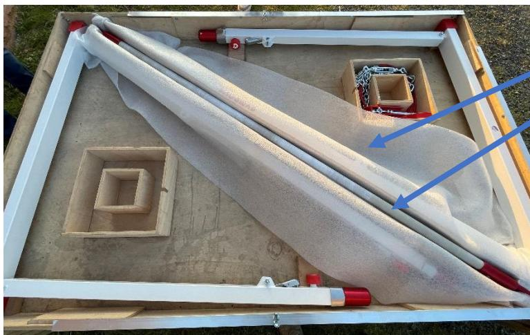
Mettre la toile de protection sur les écarteurs puis placer les deux portes mains l'un sur l'autre
