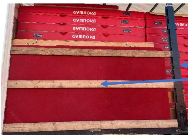
Une attention particulière doit être portée au verrouillage du poteaux ainsi que la mise en place des traverses
