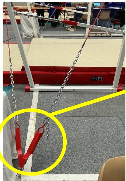
**Les deux tendeurs rapides sont positionnés sur l'encrage avant droite**
