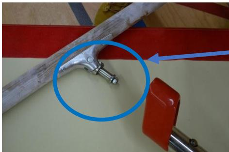
Bien remettre la rondelle et l'écrou sur le porte mains
