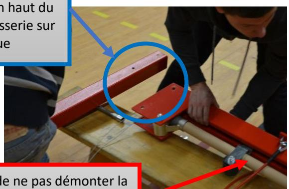
ATTENTION de ne pas démonter la tête et le système de réglage de la tête du portique
